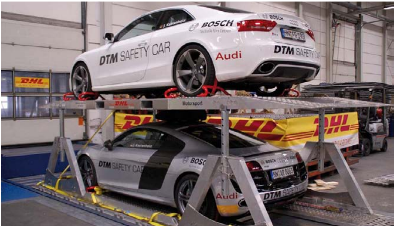
Das Doppel-Car-Rack vereinfacht die Verladung von Fahrzeugen und erhöht die Effizienz bei der Transportraumnutzung.
