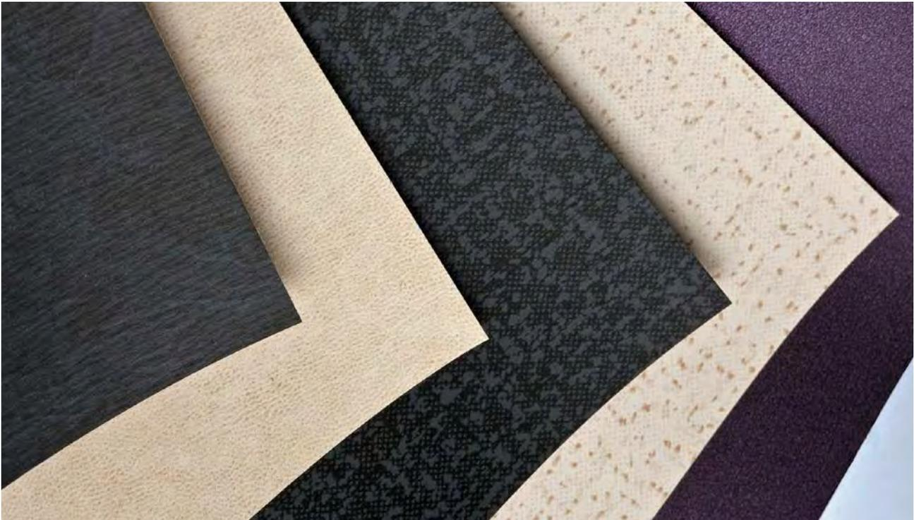
Neue Designmöglichkeiten durch Farben, Dekordrucke und Effektlackierungen: Die Dünnsfolie Decoject™ ist eine kostengünstige Alternative zu lackierten Spritzgussteilen. Foto: ContiTech
