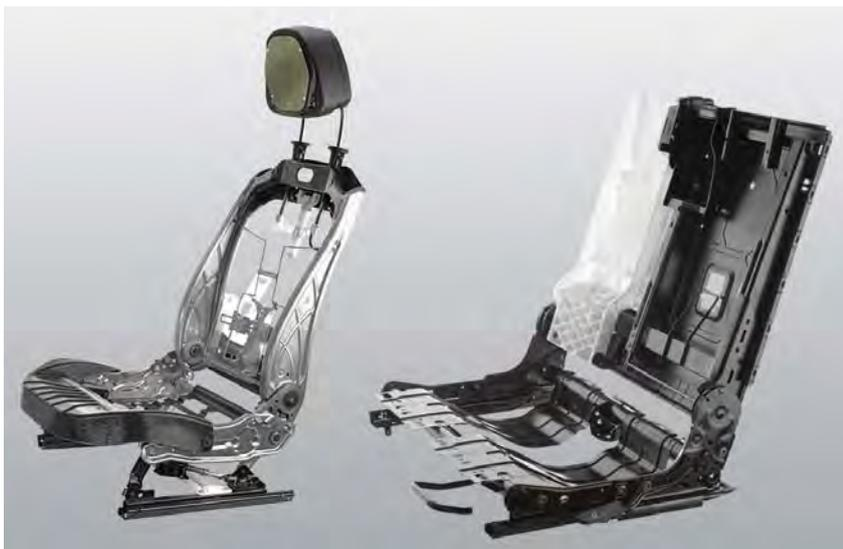
Das Leichtbausitzkonzept (li) von Brose spart ca. 4 kg Gewicht: Entscheidend ist der Materialmix aus Stahl, Kunststoff und Aluminium. Wird die Durchladefunktion einer Rücksitzbank (re) durch ein Kunststoffmodul substituiert, lässt sich das Gewicht um etwa 1,5 kg reduzieren.
