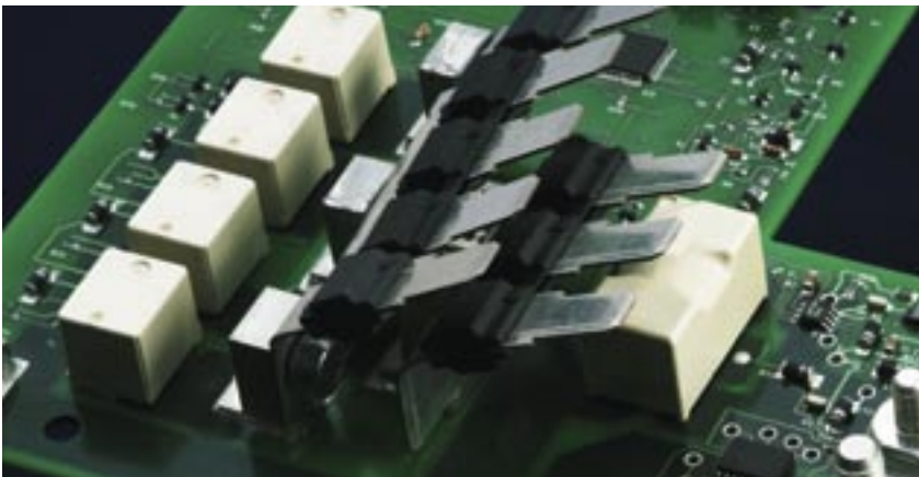
Hochstromverteiler mit Batteriemangementfunktion
