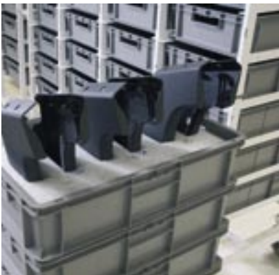
Bereitstellung der Sitzblenden in speziellen Behältereinsätzen am Montagerundlauf.
