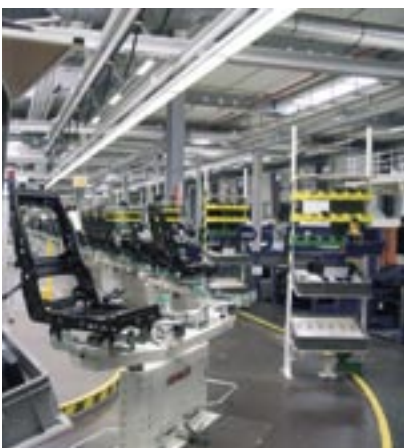
Auf dem Montagerundlauf sind alle Bauteile stets im direkten Zugriff. Dazu sind 24 gleichmäßig verteilte Gestelle installiert, die bis zu 16 Standardgreifkästen sowie zwei Standardbehälter aufnehmen können.
