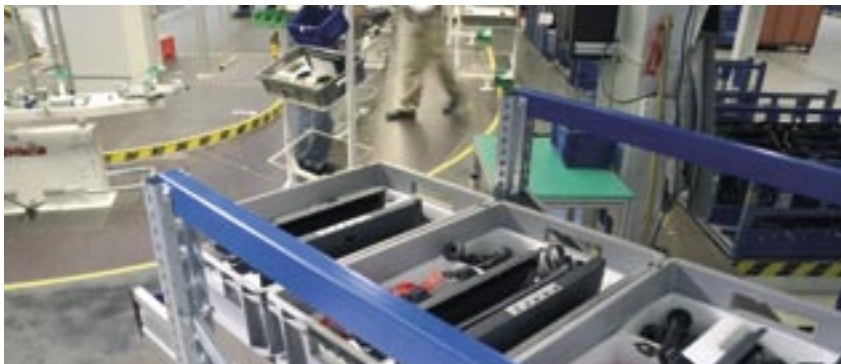
— Größere Bauteile werden in den beiden Kurvenbereichen des Montagebandes in vorkommissionierten Behältern aus bereitstehenden Kollidurchlaufregalen entnommen.
