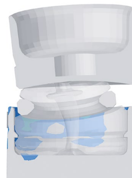
DP-Aunahme: v10 mit Stahling T=1.Smm, aufgeschumpft (T=-215°C) Kappe FL: optimierte Variante Mat. Aufnahme: EN AC44300 Mat. Stahling: 42CrMo4+QT
