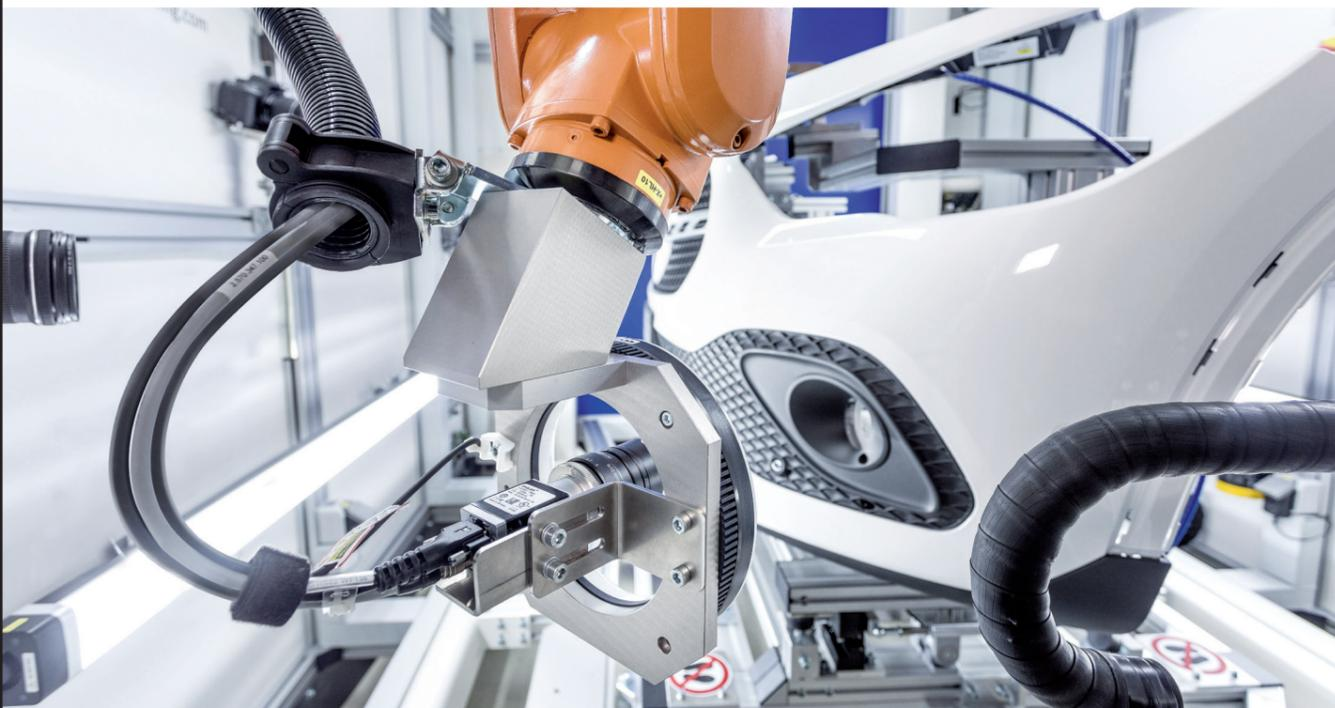
Bumper-Prüfsystem – Roboter mit Kamera
