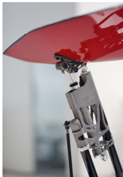
Die Konzeptstudie einer Bugatti-Chiron Heckflügel-Mechanik zeigt eine Gewichtsreduzierung von 53% im Vergleich zu einem bereits gewichtsoptimalen Serienbauteil
