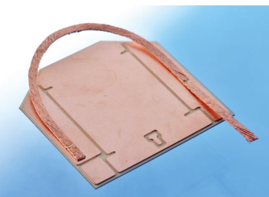
Produktbeispiel 2: Laserstrahlschweißen auf der Mikrometerskala: Schweißen eines kompaktierten Litzenleiters auf ein Printed Circuit Board.
