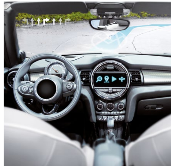
Das AR HUD projiziert virtuelle Hinweise direkt auf die reale Umwelt vor dem Fahrzeug © shutterstock_653238769
