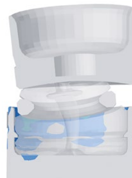
DP-Aunahme: v10 mit Stahling T=1.5mm, aufgeschumpft (T=-215°C) Kappe FL: optimierte Variante Mat. Aufnahme: EN AC44300 Mat. Stahling: 42CrMo4+QT
