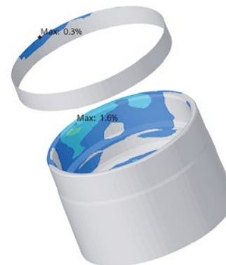
DP-Aunahme: v10 mit Stahling T=1.5mm, aufgeschumpft (T=-215°C) Kappe FL: optimierte Variante Mat. Aufnahme: EN AC44300 Mat. Stahling: 42CrMo4+QT
