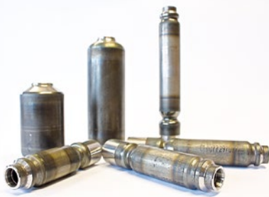
Rohrformung (hier: Airbag-Rohre)
