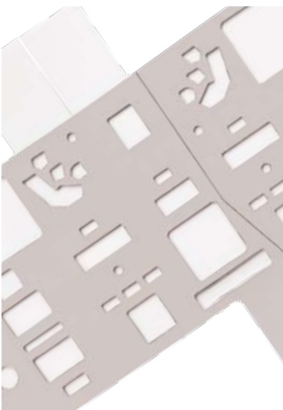
Verklebung im Klimasteuerungsgerät
