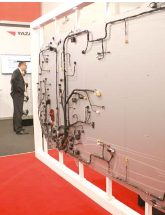
Entwicklung und Herstellung eines Kabelbaum-Exponats
