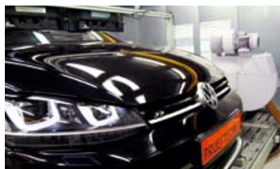
Erprobung auf dem weltweit schnellst regelnden Prüfstand R2R Road to Rig
