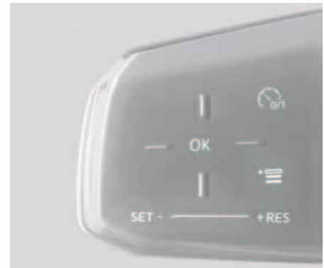
Touchschalter mit haptischen Feedback
