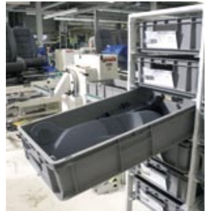
SSI Schäfer-Spezialbehälter mit verändertem Längenmaß.
