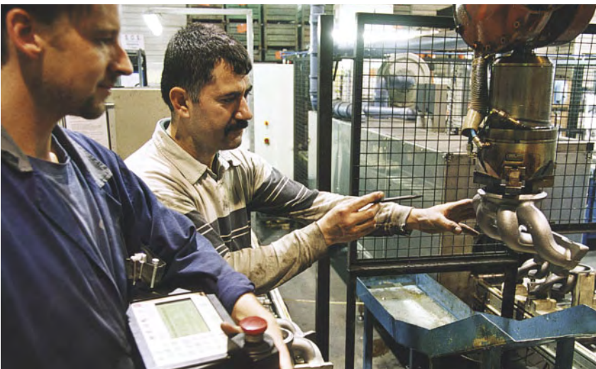
Präzise. Beim Gießen verlaufen viele Arbeitsgänge rasch und genau. Industrieroboter lernen den Bewegungsablauf dazu im sogenannten Teach-In-Verfahren zunächst unter Aufsicht.
