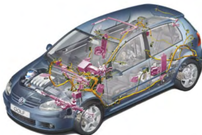
Elektrik / Elektronik im Golf 5
